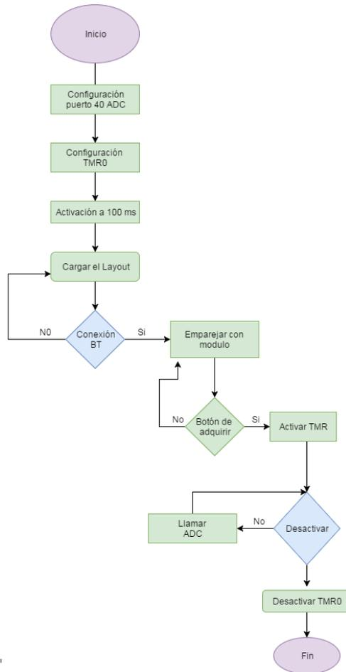
En la figura se explica la forma en el que trabaja el algoritmo que usa la App mediante un diagrama de flujo, en la cual se envía la señal obtenida por el sensor y convertida a una señal digital por el OPAMP, para que de esta forma el envío de datos sea más exacta al App.
